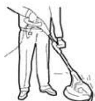
Fii atenți la cablul de alimentare cand schimbi direcția. Tineti trimmerul în fața dumneavoastră la un unghi la care aparatoarea este paralela cu iarbă. Ghidati trimmerul într-o
