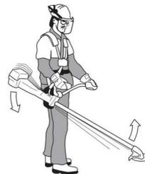
Puneti echipamentul pe pamant si reglati pozitia inelului de suspensie pentru obtinerea unui echilibru corect
